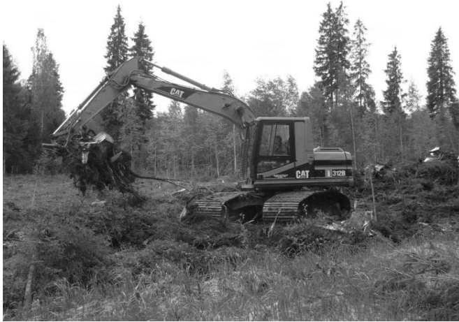
Kuva 1. Kaivinkone kannonnostossa turvemaalla (Kuva: Jussi Laurila).
