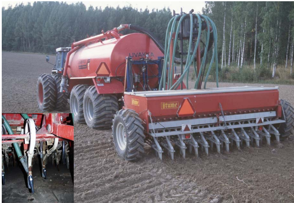
Kuva 1. Lietelannan sijoittamiseen ja suojaviljan kylvöön käytetty laitteisto (Kapuinen 2001).
