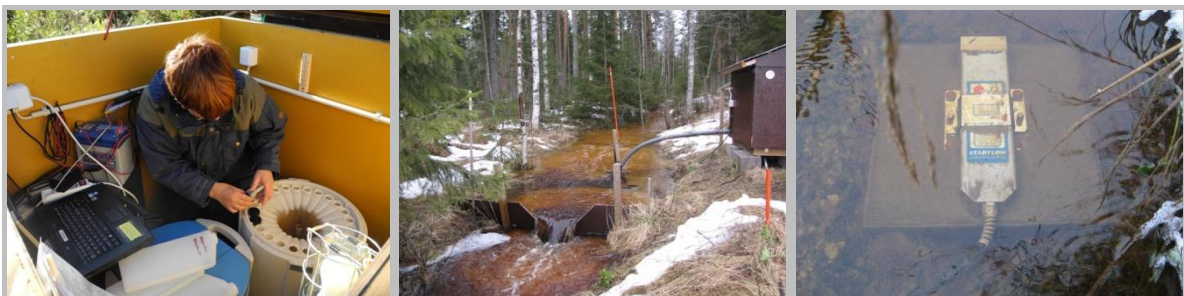
Kuva 2. a) Lämmitettävä näytteenottokoppi, johon on sijoitettu näytteenotin ja dataloggerit, b) V-mittapato ja c) akustinen virtaamamittari. Kuvat: a) MTT/Kirsi Järvenranta, b) ja c) MTT/Mari Rätty.
