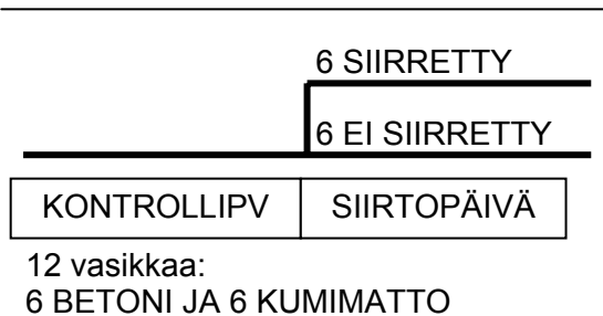
Kuva 1. Koeasetelma. BETONI: yksilökarsina, jossa purukuivitettu betonipohja, KUMIMATTO: yksilökarsina, jossa betonin päällä 5cm paksu purukuivitettu kumimatto. Molempien mitat 1.8 * 1.05 m.
