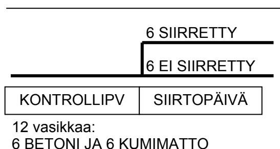
Kuva 1. Koeasetelma. BETONI: yksilökarsina, jossa purukuivitettu betonipohja, KUMIMATTO: yksilökarsina, jossa betonin päällä 5cm paksu purukuivitettu kumimatto. Molempien mitat 1.8 * 1.05 m.
